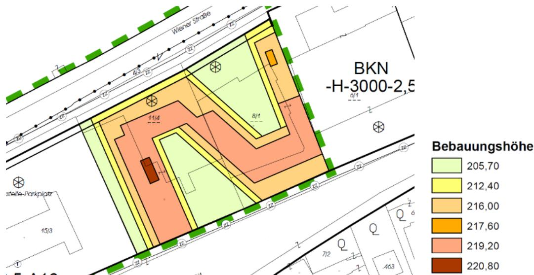
Abbildung 24: Darstellung der Höhenentwicklung im Bereich der Projektfläche 2
